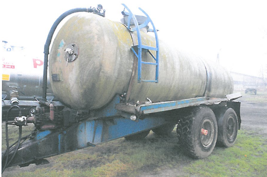
Rama posiada liczne ubytki lakieru i ślady korozji.
