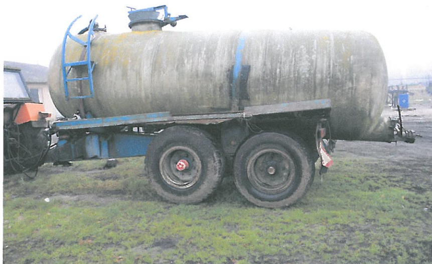
Rynny boczne skorodowane na wskroś z licznymi ubytkami. Instalacja oświetleniowa niesprawną (zniszczone lampy i przewody).
