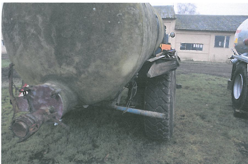
Wsporniki oświetlenia, błotniki i osłony metalowe – skorodowane i pourywane.
